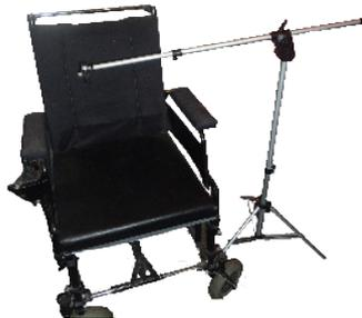
El soporte de pie permite ubicar el Switch en un posición que resulte cómoda para el usuario. De esta manera, el dispositivo se ubica en función de la capacidad motora del usuario para su utilización. Permite ubicarlo de forma independientemente del entorno ya que utiliza un sistema de pie sin anclaje.
