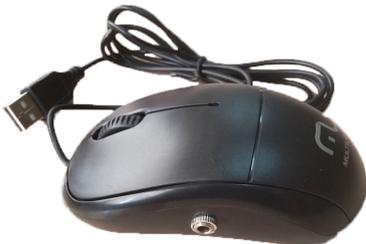
El mouse adaptado es un dispositivo mouse tradicional al que se le han adaptado las acciones de clic izquierdo y derecho para poder realizar dichas activaciones desde un switch externo.
