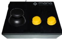
El mini joystick es un dispositivo, más pequeño que el Joystick mouse, que permite desplazar el puntero del mouse a través del movimiento de una pequeña palanca y permite realizar el click izquierdo y click derecho mediante dos botones.
