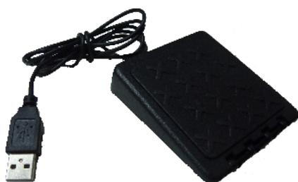
El Switch Pedal es un dispositivo que permite realizar la acción de click izquierdo de un mouse convencional.
