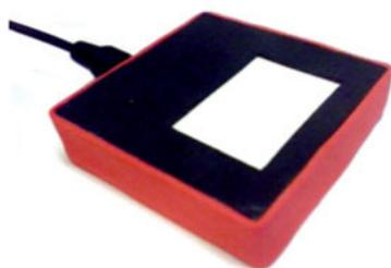
El Switch táctil es un dispositivo que permite realizar la acción de click izquierdo de un mouse convencional.
